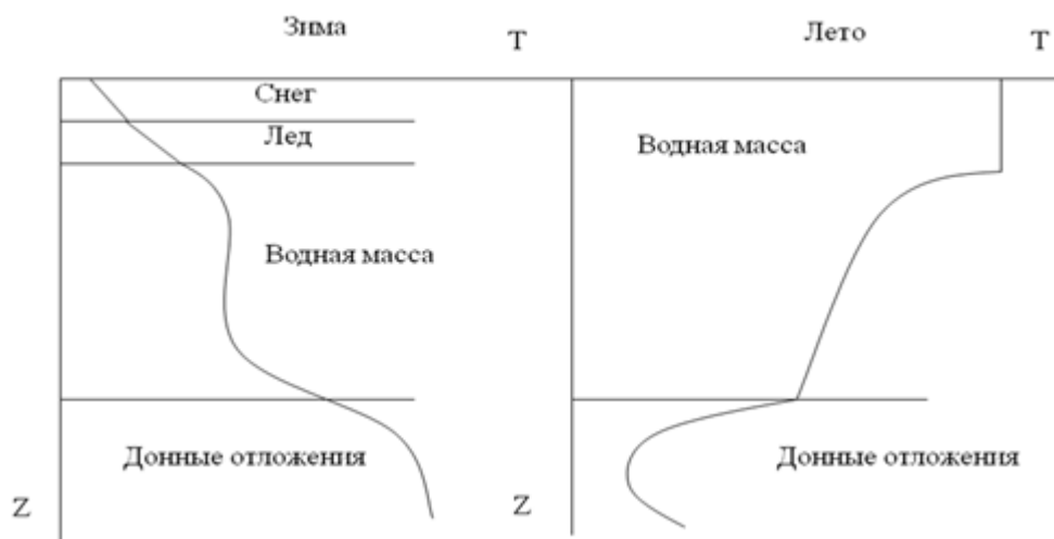
Рисунок 3. Схема вертикального профиля температуры в системе «снег – лед – водная масса – донные отложения», реализованная в модели FLake
